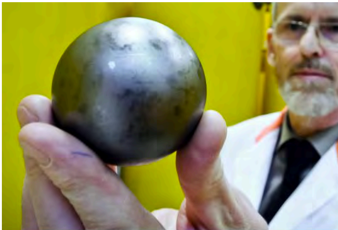
Rudolf Printz, Leiter des Bereiches Nuklear-Service im Forschungs-Zentrum Jülich, zeigt das Modell einer Graphit- Brennelemente-Kugel. (Andreas Endermann (dpa))
